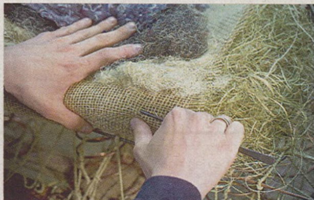
Das Polster: Mit der Nadel werden die Schichten befestigt.
